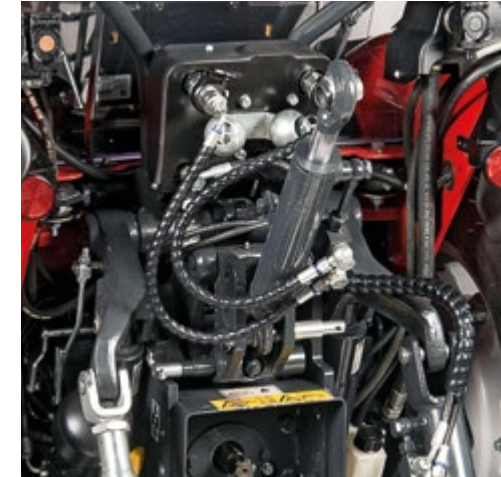
TIRANT HYDRAULIQUE ET TROISIÈME POINT* Ils corrigent la mise en place et l'inclinaison des outils.
