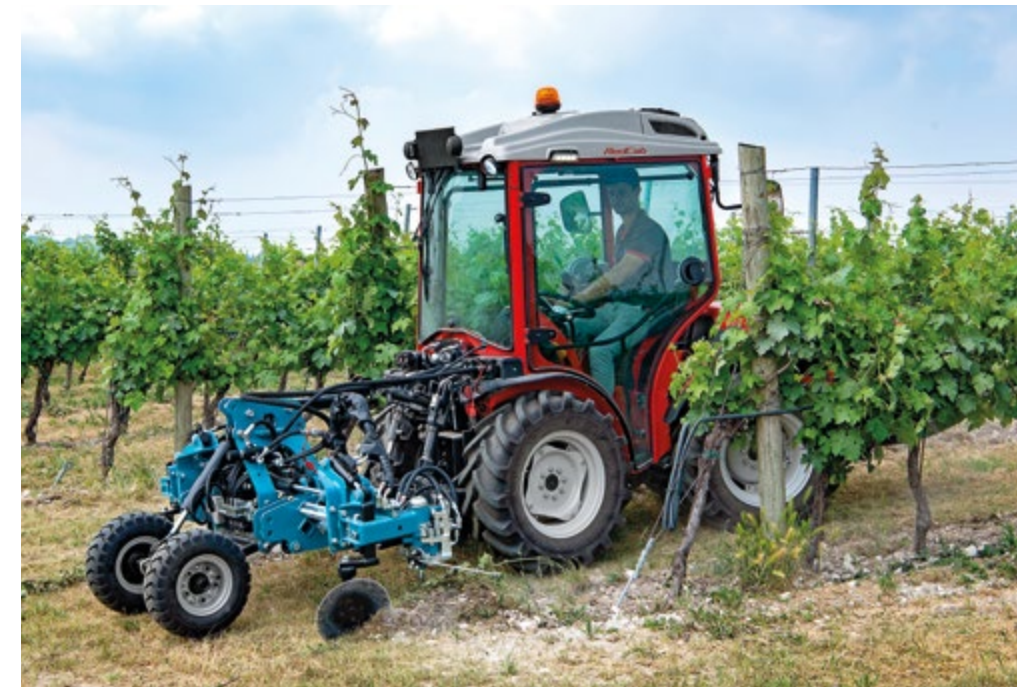
SYSTÈME HYDRAULIQUE Système hydraulique modulaire pouvant compter jusqu'à 11 prises hydrauliques au choix entre les versions à refoulement continu, double effet et retour libre. Toutes les connexions sont desservies par des tuyaux hydrauliques à section majorée afin de réduire les pertes de charge et rendre le circuit plus performant.
