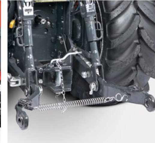
RELEVAGE HYDRAULIQUE Bras de relevage réglables, raccords rapides coulissants cat. 2.
