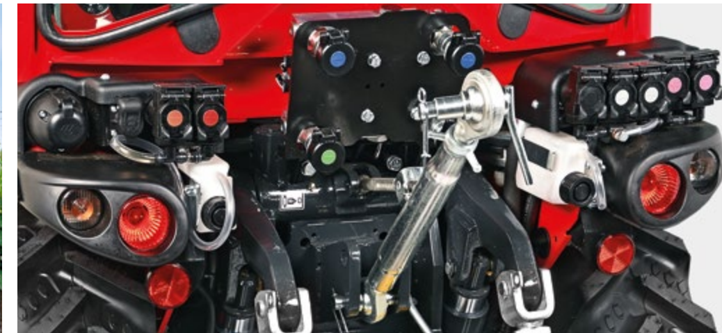
SYSTÈME HYDRAULIQUE Système hydraulique modulaire pouvant compter jusqu'à 11 prises hydrauliques au choix entre les versions à refoulement continu, double effet et retour libre. Toutes les connexions sont desservies par des tuyaux hydrauliques à section majorée afin de réduire les pertes de charge et rendre le circuit plus performant.
